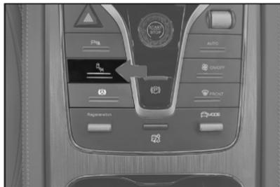
Os motoristas podem ligar ou desligar a função do sistema de monitoramento de ponto cego através do interruptor físico\* ou da interface de configuração do sistema multimídia → **Dipilot**. Quando o veículo é iniciado, o sistema retorna para o último estado de configuração.
