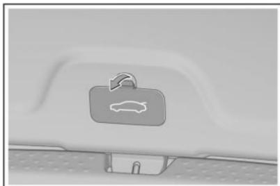
1. Remova a tampa da porta de manutenção da tranca da tampa do porta-malas da proteção da tampa do porta-malas.
