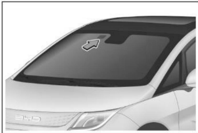
A janela de micro-ondas de identificação eletrônica do veículo está localizada no lado superior direito do para-brisa dianteiro.
