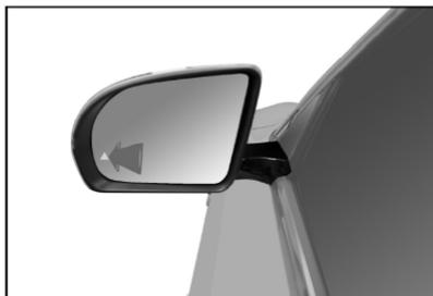
Com o veículo em velocidade superior a 30 km/h, quando os sensores de radar detectarem veículos nas áreas de ponto cego de um espelho lateral, o indicador de advertência no espelho lateral correspondente vai acender. Se o sinalizador de direção (seta) for ativado para o mesmo lado neste caso, o indicador de advertência no espelho retrovisor externo piscará, indicando possível risco se o motorista continuar com a mudança de faixa, alertando-o para que possa dirigir com segurança.
