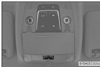
A luz interna dianteira pode ser ligada tocando na tampa da luz interna dianteira em qualquer modo de energia.
