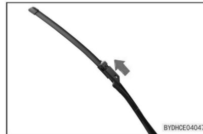
4. Instale a nova palheta do limpador na ordem inversa à remoção.
