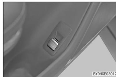
Com o veículo destravado, puxe a tampa do porta-malas elétrico para abri-la.
