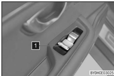
A alavanca de ajuste **1** do banco traseiro está localizada no revestimento da porta traseira. Puxe a alavanca para trás ou para frente para ajustar o encosto do ângulo para frente ou para trás.
