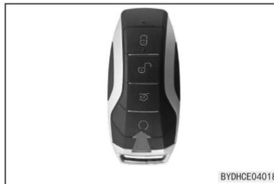
1. Pressione e segure o botão REMOTE START/STOP na chave inteligente por 2 s para ligar o veículo. Depois que o sistema do veículo for iniciado com sucesso, os indicadores de direção (setas) piscarão 3 vezes.
