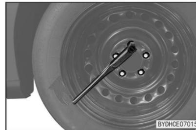
8. Abaixe o veículo completamente, aperte as porcas da roda e instale as coberturas das porcas da roda.
