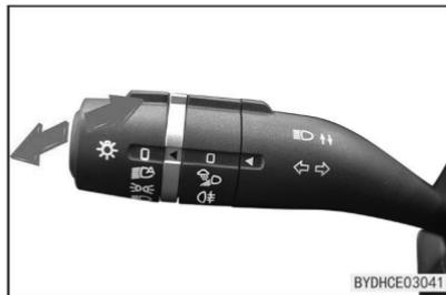
Puxe o interruptor das luzes (na direção do volante de direção) a partir da sua posição original para fazer um sinal de ultrapassagem. Ao soltar, o interruptor retorna automaticamente, desligando o sinal de ultrapassagem.
