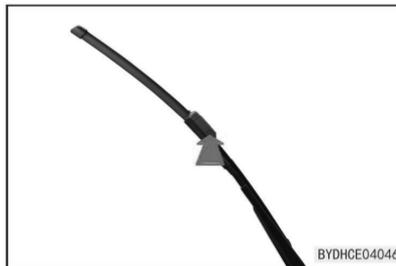
3. Segure a palheta na região da presilha de travamento e remova a palheta na direção conforme mostrado na figura.
