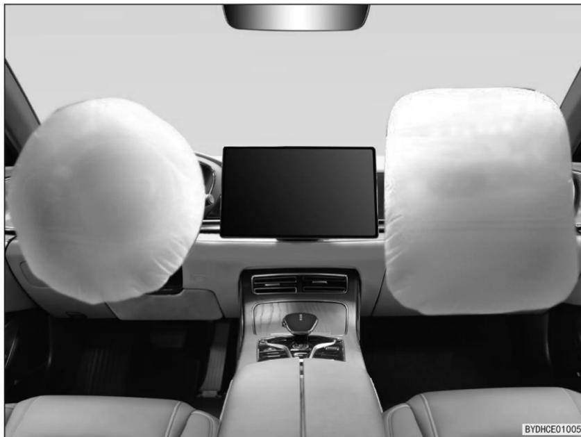
Caso a ECU do sistema de proteção complementar identifique uma condição de colisão frontal de gravidade média a severa durante a condução do veículo e as condições de acionamento dos airbags dianteiros sejam satisfeitas, os airbags serão acionados para reduzir o risco ou a gravidade de ferimentos.
