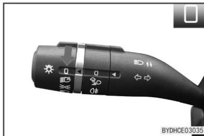
Gire o interruptor das luzes até a posição "☀️" para desligar todas as luzes, exceto a luz de condução diurna. Quando a função de luz diurna no PAD está ligada, a luz diurna neste modo acende. Quando a função de luz diurna no PAD está desligada, a luz diurna neste modo se apaga.
