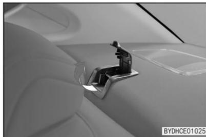
3. Prenda a trava da cinta de retenção superior no suporte de ancoragem, em seguida, aperte a cinta de retenção superior. Certifique-se de que a cinta está fixada corretamente.
