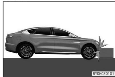
A extremidade dianteira do veículo bater no chão quando estiver em uma descida.
