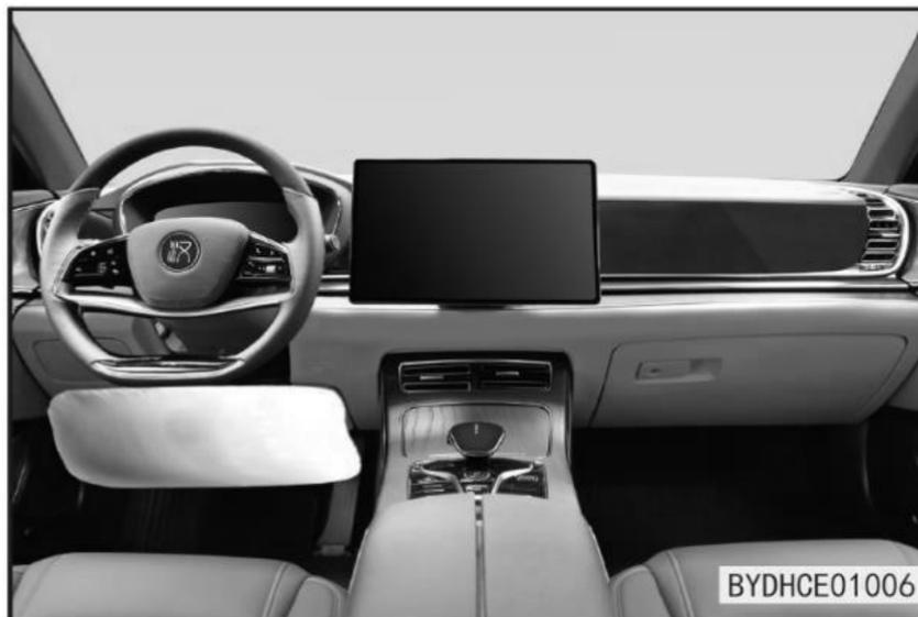
Se o veículo que você selecionou for equipado com airbags de joelho (localizado na proteção inferior do painel), quando o SRS ECU sofrer uma colisão média a severa enquanto o veículo estiver em movimento e as condições de acionamento forem satisfeitas, o airbag de joelho será acionado para proteger as pernas dos passageiros e reduzir o grau da gravidade dos ferimentos.
