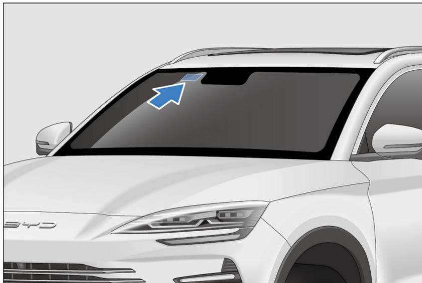
O adesivo da posição de montagem do transponder está localizado na parte superior direita do para-brisa dianteiro.
