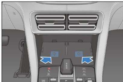
O carregamento sem fio do smartphone é localizado na região do console central. O motorista/passageiro pode ligar ou desligar a função de carregamento sem fio do smartphone na interface "Convenient" (Conveniente) depois de deslizar para baixo a barra de status na parte superior da central multimídia. O sistema é ativado por padrão.
