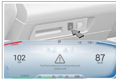
O painel de instrumentos lembra de reabastecer após o término da liberação de pressão.
