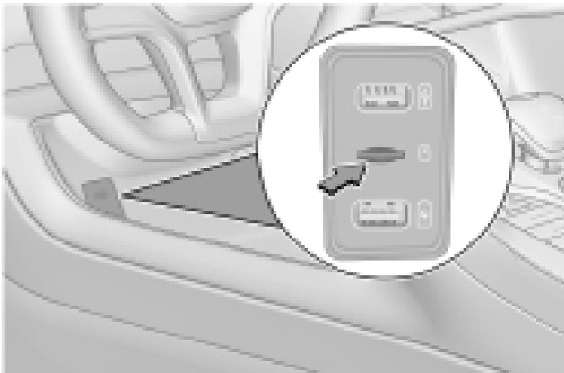
Um slot para cartão SD é fornecido na extremidade inferior do console central no lado próximo ao assento do motorista.
