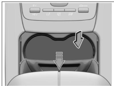
O porta-copos do banco dianteiro fica no console central. Deslize a tampa do porta-copos para trás para abri-la. O porta-copos tem duas posições de montagem e pode ser removido e remontado para atender às necessidades de diferentes profundidades de uso.
